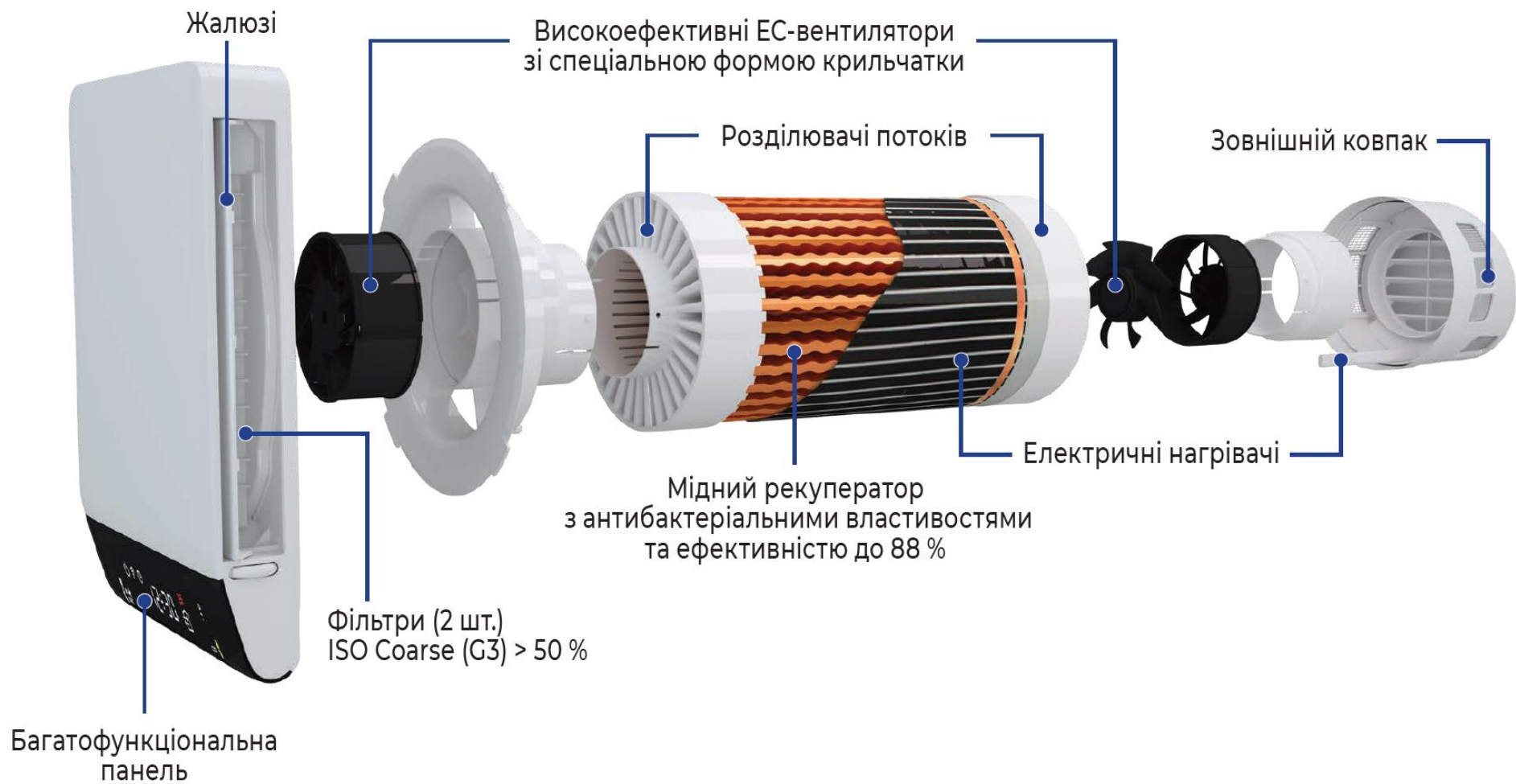
Рис. 1.5. Конструкція установки Breezy
