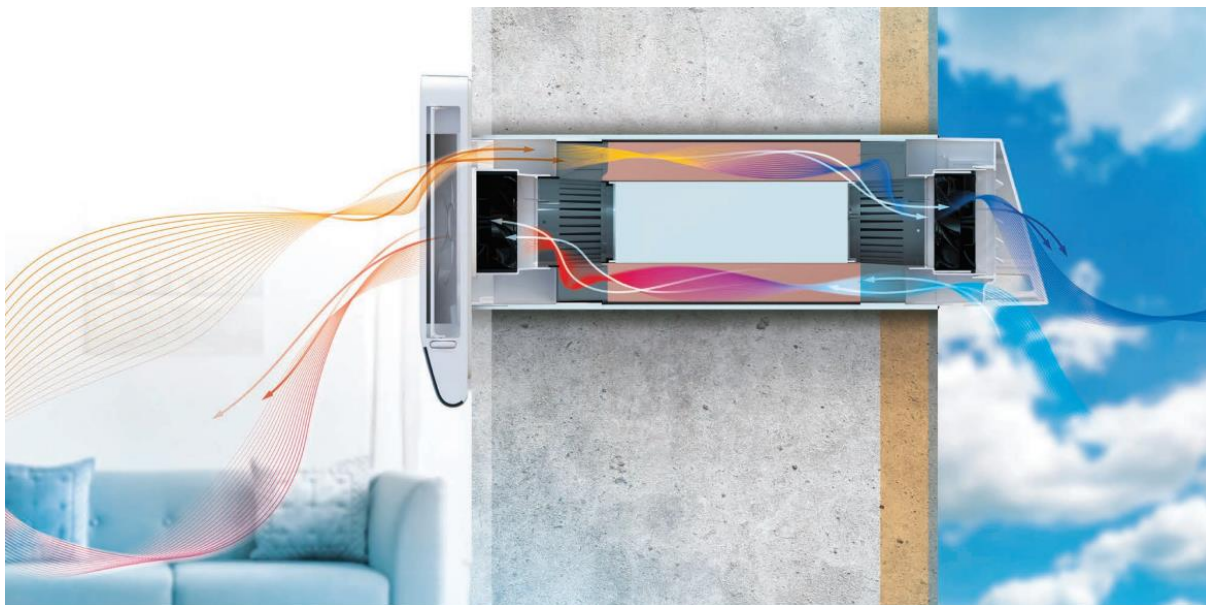
Рис. 1.6. Принцип роботи установки Breezy
