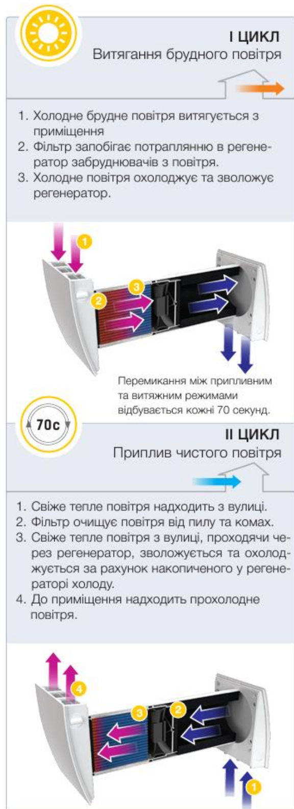
Рис. 1.7. Принцип роботи установки Vents Twin Fresh [8]
