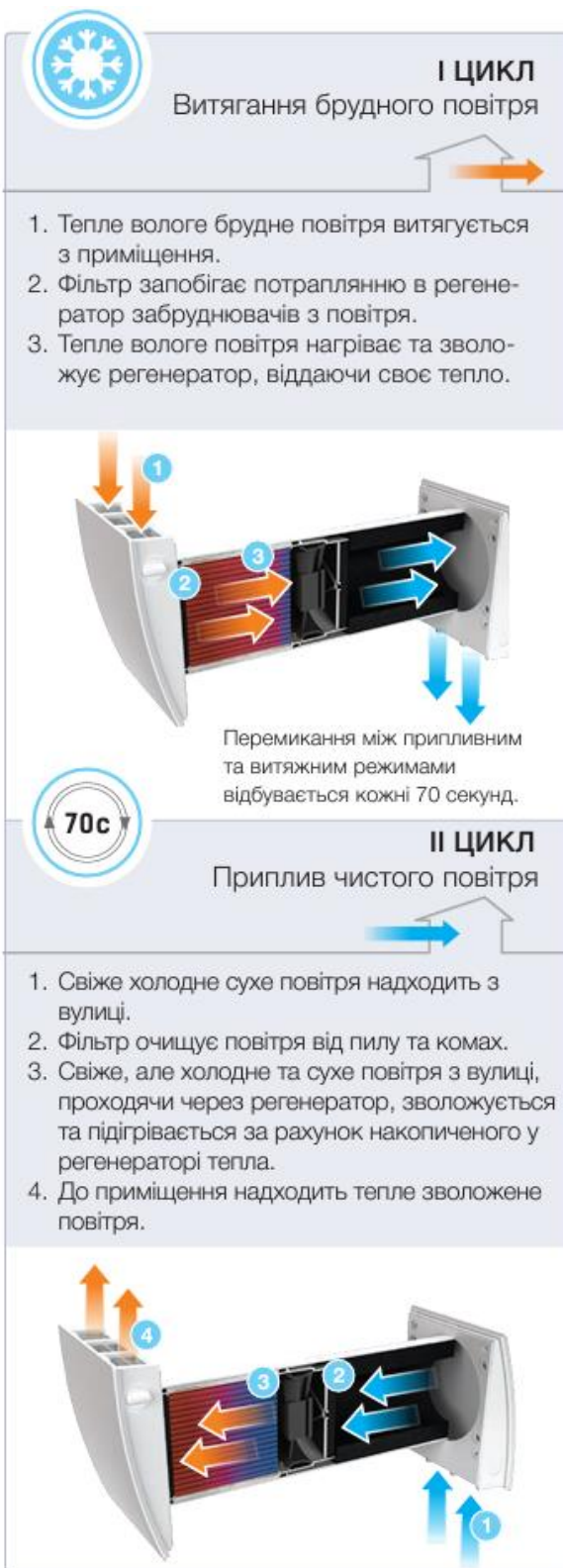
Рис. 1.7. Принцип роботи установки Vents Twin Fresh [8]
