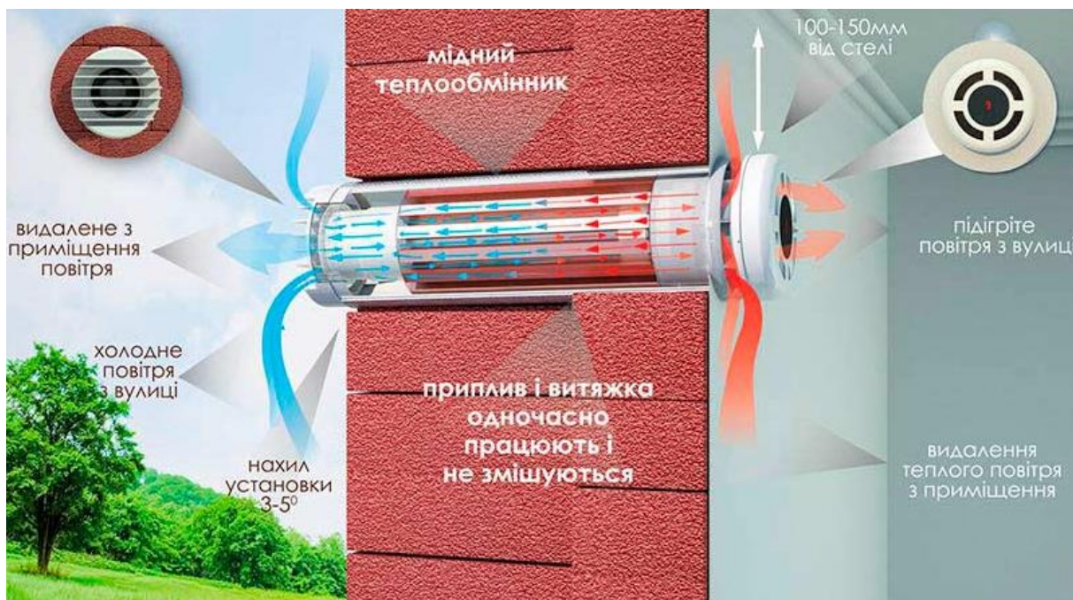
Рис. 1.4. Принцип роботи установки Prana [6]
